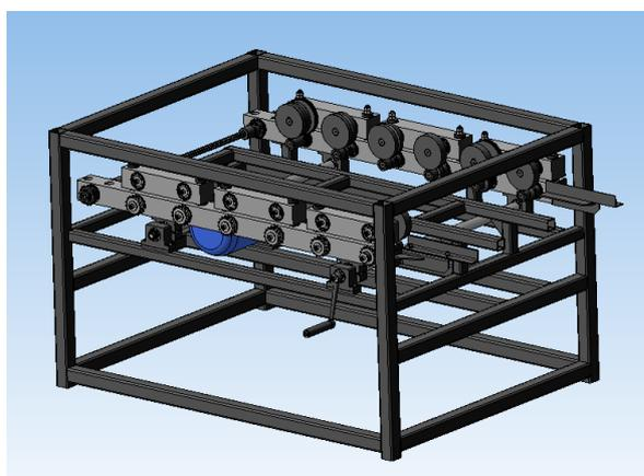
Профилировочные станки серии Зв используются для производства полосы с завальцованными кромками методом холодного профилирования. Полученная полоса служит заготовкой для последующего изготовления элементов кровли, фасадов зданий.
