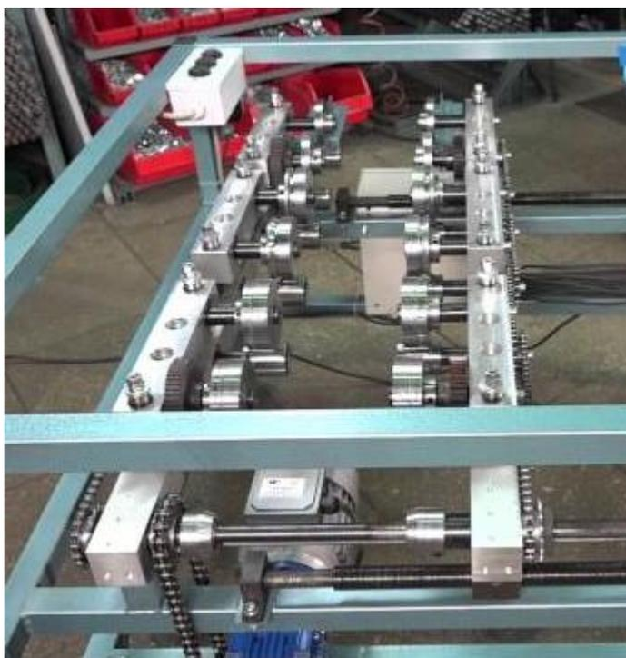
Профилировочные станки серии ЗВ.Р используются для завальцовки кромок на металлической полосе. Основным отличием от станка Зв-05.600 является возможность проката заготовки за один проход.
