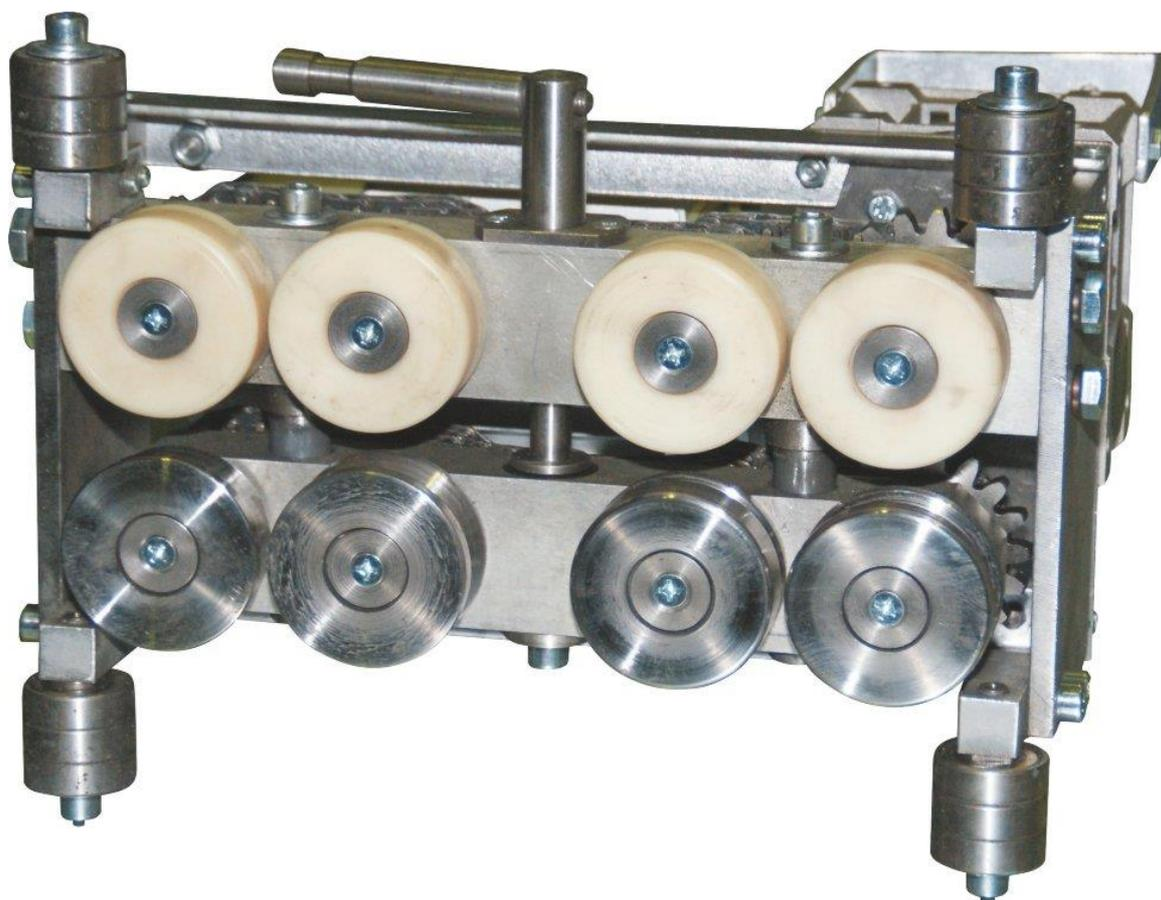
Электрическая фальцезакаточная машинка ФЗМ предназначена для закрытия двойного стоячего фальца на кровле. Имеет уникальную конструкцию профилирующих и протягивающих роликов, обеспечивающих качественное обжатие замка. Невысокая цена машинки гарантирует быструю окупаемость после покупки.
