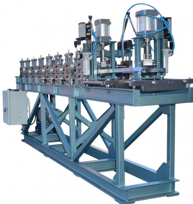
Станок для профиля серии ГК предназначен для изготовления оцинкованных металлических профилей, применяемых при устройстве конструкций из гипсокартона. В качестве заготовки используется либо штрипс определённой ширины, либо полосы той же ширины и необходимой длины. Выпускает стандартизированные профили - ПП 60x27 и ППН 28x27, ширина заготовки соответственно 123 мм и 81 мм.
