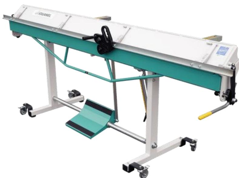
Мобильный листогиб РСХ-2500/0,8 предназначен для гибки доборных элементов кровли и фасадов, а также деталей прямоугольных воздуховодов. Станок сочетает в себе преимущества мобильного и цехового листогиба. Являясь самой мощной моделью в сегменте легких станков в мире, листогиб РСХ-2500 при массе в 240 кг позволяет гарантированно гнуть сталь толщиной до 0,8 мм, сохраняя при этом постоянную геометрию профиля по всей длине.
