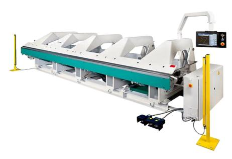
Промышленный листогиб серии ПГЛ8000-20 предназначен для серийной гибки профилей большой длины до 8050 мм из стали толщиной 2,0 мм в рамках большого производства. Несмотря на огромный вес и высокотехнологичную начинку, достаточно прост в использовании.
