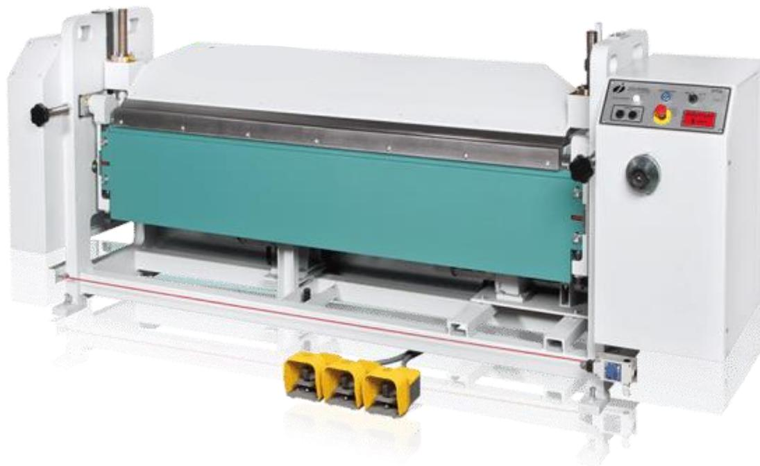
Электромеханический листогибочный станок ПТН2550-20ЕЕ предназначен для изготовления различного спектра изделий для кровли, лифтов, дверных коробок фасадов и вентиляции из стали максимальной толщиной до 2,0 мм и длиной до 2550 мм.
