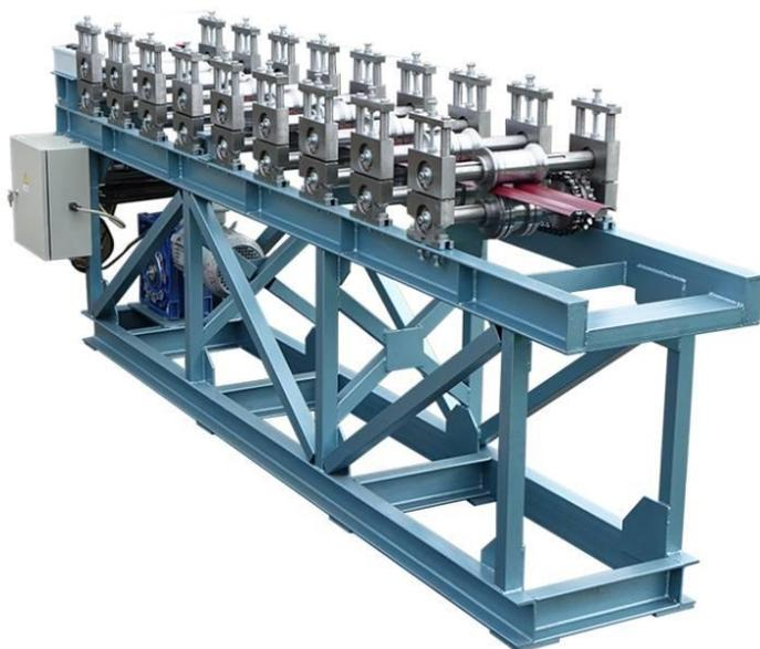
Профилировочные станки предназначены для изготовления металлического профиля (ламели), используемого при устройстве заборов "Жалюзи". Станок может прокатывать оцинкованную сталь, в т.ч. с полимерным покрытием (покрытие может быть, как одностороннее, так и двухстороннее).
