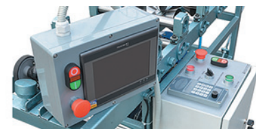
Автоматическая система управления с сенсорной панелью оператора
