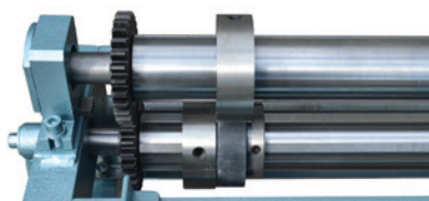
Ножи продольной резки с поддерживающей обрезающей втулкой
