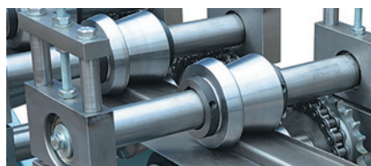
Ролики из легированной конструкционной стали
